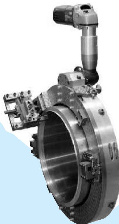
Труборез "ТРР-325" с электроприводом и с установленным расточным суппортом.
