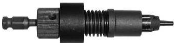
Конструкция вальцовки для труб с внутренним диаметром до 12 мм
