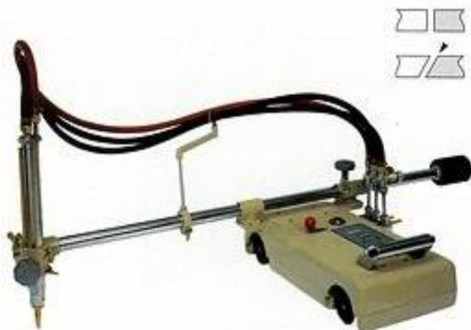
редукторов давление газов в соответствии с рекомендациями таблицы для определенной толщины стальной плиты.
